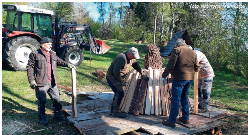
Zum Errichten des Kohlemeilers auf der Köhlerwiese braucht es viele helfende Hände. Im Inneren befindet sich ein Reisigbündel, das mit Holzschichten umschichtet wird.
